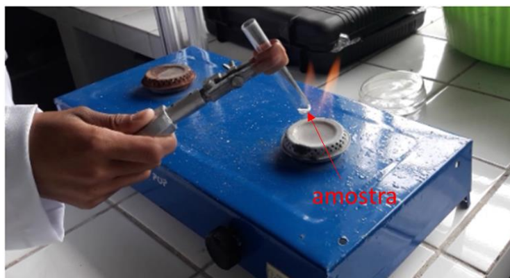
Figura 5 – Ilustração do procedimento de determinação da fusibilidade das amostras poliméricas.
