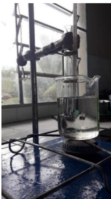
Figura 6 – Montagem experimental para determinação da faixa de temperatura de fusão das amostras poliméricas.
